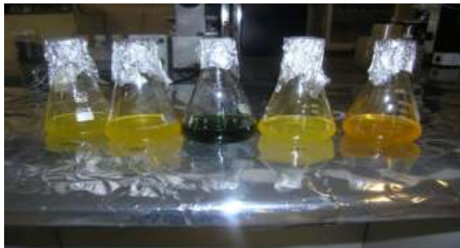
شکل ۲-۹- تغییر رنگ محیط از سبز به زرد در اثر رشد باکتری‌های اکسید کننده گوگرد و اسیدی شدن محیط
