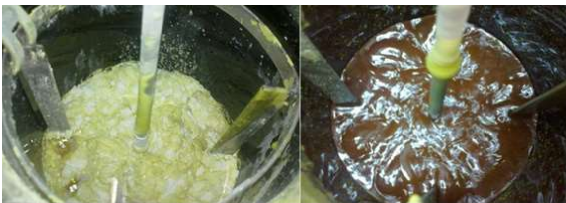
شکل ۱-۱۵- الف) تصویر گوگرد مذاب در داخل مخزن اختلاط. ب) ایجاد فوم به دلیل ورود نامناسب بنتونیت به مخزن
