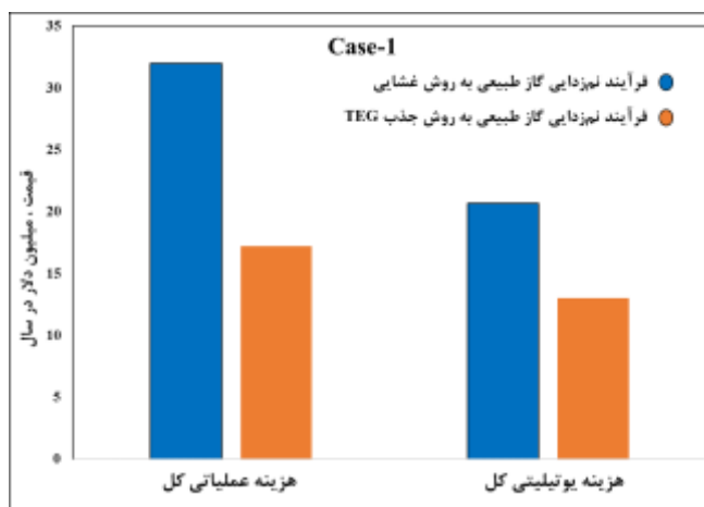
شکل ۷ - نمودار مقایسه هزینه‌های عملیاتی و مصرفی کل فرآیند نمزدایی از گاز طبیعی به دو روش غشایی و حلال TEG (دبی جریان طبیعی ۲۴۲۱۰ کیلومول بر ساعت، Case-1)
