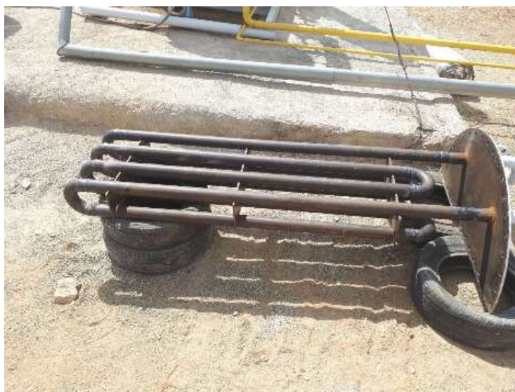
(شکل ۶) نمایی از مجموعه کویل های گرمکن ایستگاه ماویان
