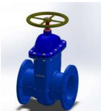
شکل ۳: مدل سازی شیر دروازه ای گوه ای توسط نرم افزار سالیدورکس
