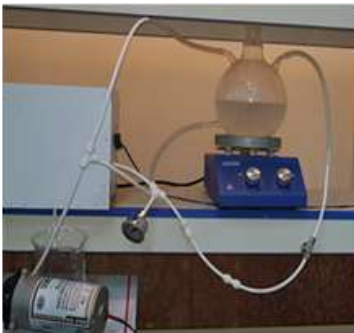
شکل ۱- تصویر سامانه تست غشایی شامل مخزن خوراک، همزن مغناطیسی، پمپ، مدول غشایی، محفظه شامل منبع نور، جریان عبور کرده از غشا، جریان باقیمانده پشت غشا، فشار سنج، شیر سوزنی
