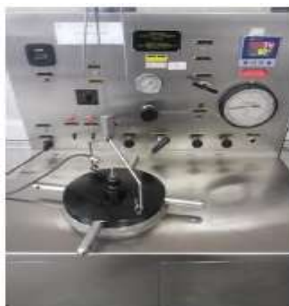
شکل ۱ : دستگاه اندازه گیری مقاومت ژله‌ای سیمان
