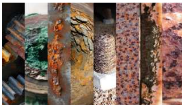
شکل (۲): به ترتیب از راست به چپ: خوردگی یکنواخت، شکافی، حفره ای، گالوانیک، فرسایشی، بین دانه ای، روی زدایی، محیطی
