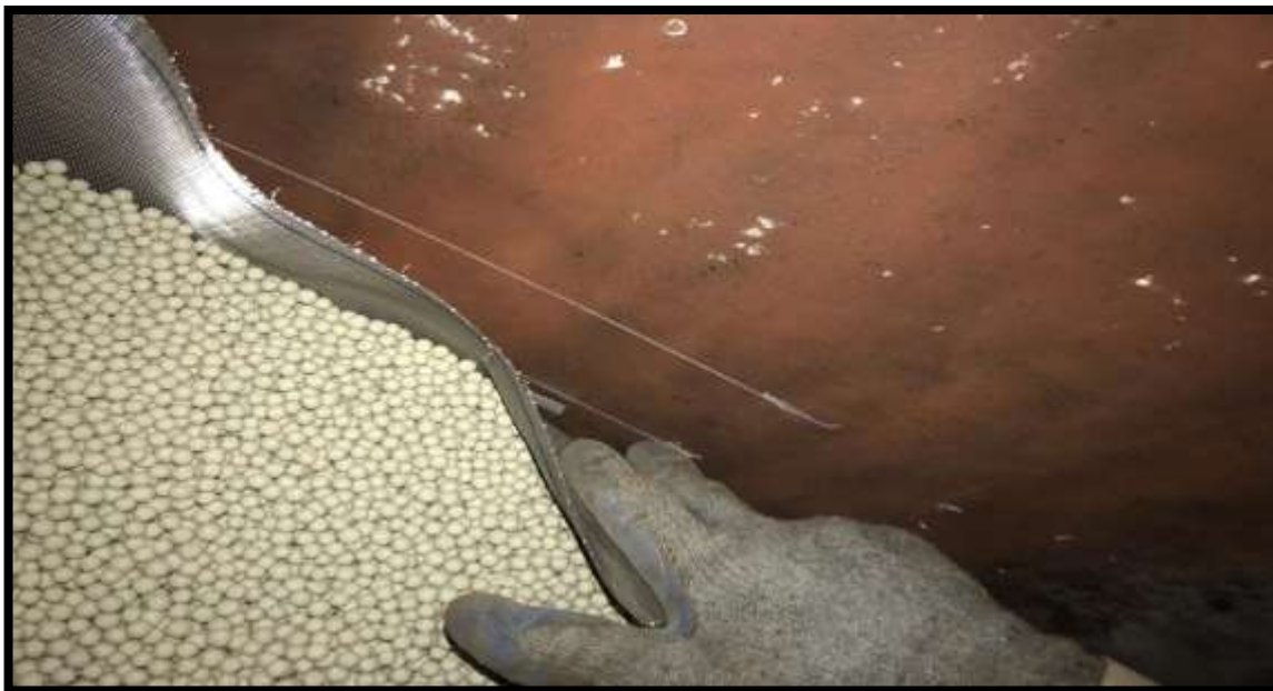
شکل (۸) اورلب وایر مشها در درایرها
