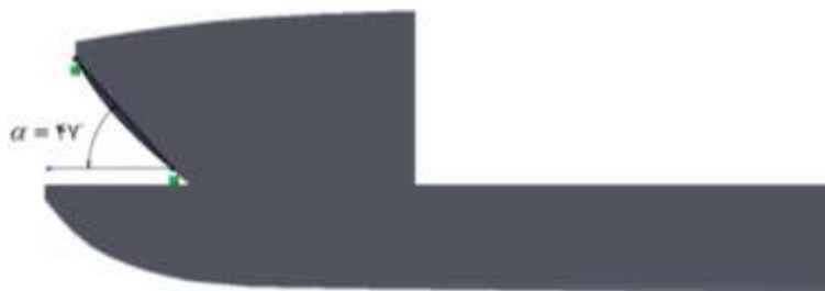
شکل ۲: مدل ۱ با شیب طولی تند ( \alpha = 47^\circ )
