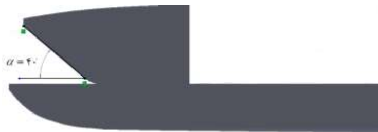
شکل ۴: مدل ۳ با شیب طولی متوسط ( \alpha = 40^\circ )
