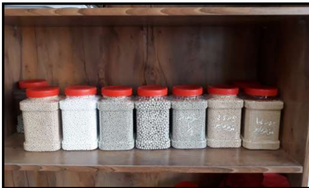
شکل (۳) نمای ظاهری مولکولارسیوهای مورد استفاده در پالایشگاه گاز بید بلند ۲
