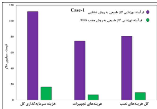
شکل ۶ - نمودار مقایسه هزینه خرید تجهیزات، هزینه نصب و سرمایه‌گذاری فرآیند نمزدایی از گاز طبیعی به دو روش غشایی و حلال TEG (دبی جریان طبیعی ۲۴۲۱۰ کیلومول بر ساعت، Case-1)
