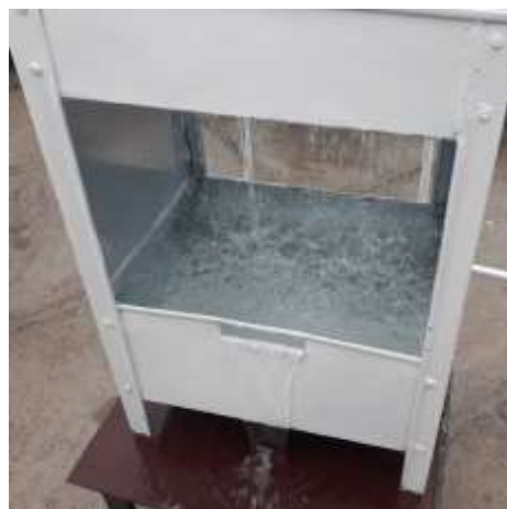
شکل ۲. نمونه یک برج خنک کننده ساده بدون استفاده از توپ پینگ پنگ
