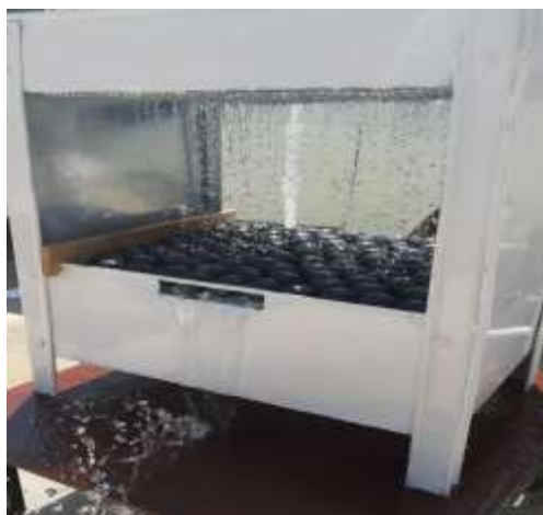
شکل ۴. نمونه یک برج خنک کننده ساده به همراه توپ های پینگ پنگ
