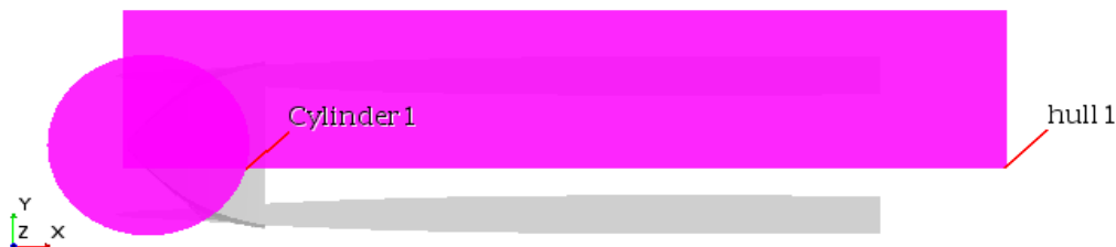
شکل ۸: حجم های مکعبی و استوانه ای ایجاد شده جهت افزایش یکنواختی و کنترل شبکه ی نزدیک شناور
