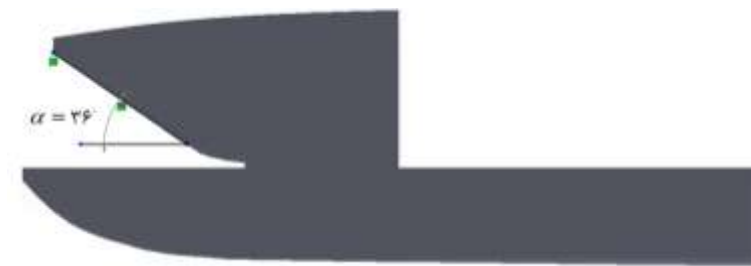
شکل ۲: مدل ۲ با شیب طولی ملایم ( \alpha = 36^\circ )
