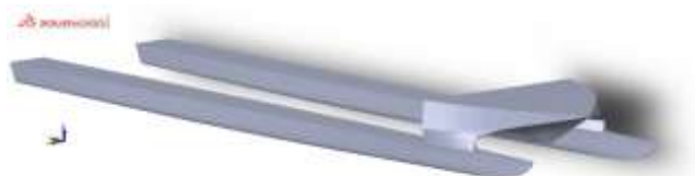
شکل ۷: مدل اینکت نهایی با الحاق سینه به کاتاماران
