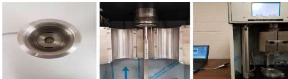
شکل ۵- مراحل مختلف راه اندازی دستگاه استفاده شده در تعیین هرزروی سیال حفاری دینامیک برای نمونه های مغزه و دیسکها [5].
