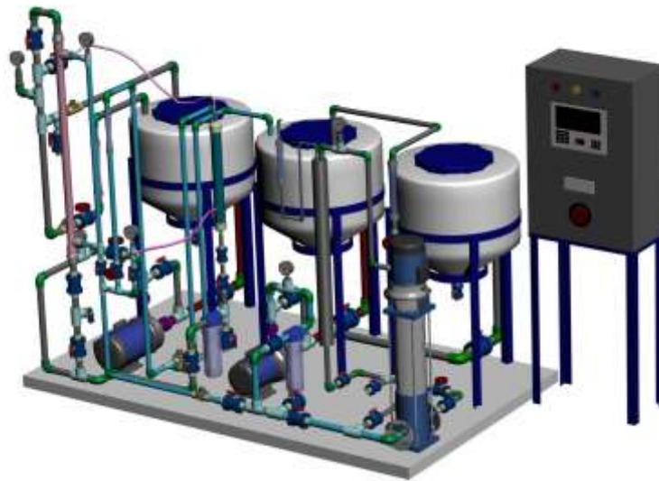
Fig. 2. Membrane module filtration setup
