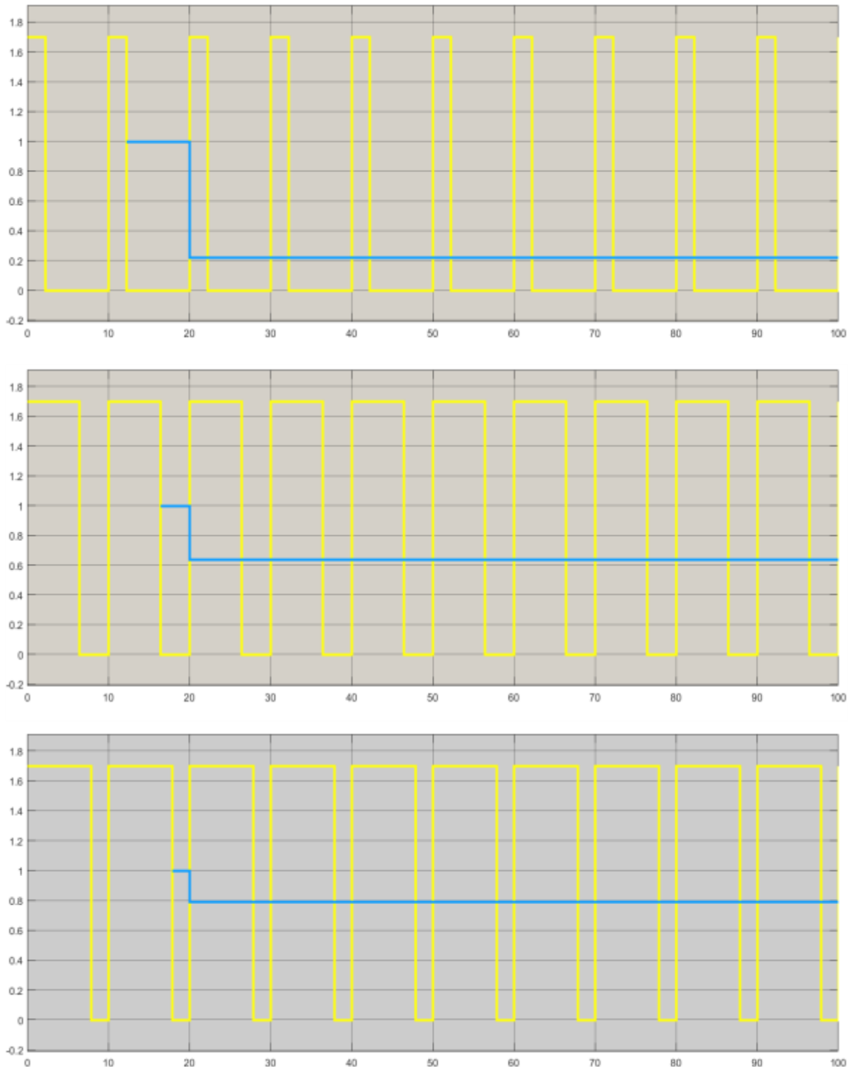
شکل ۲) آزمایش عملکرد طرح اندازه‌گیری چرخه کاری سیگنال پالسی. خطوط زرد سیگنال و خطوط آبی مقدار چرخه کاری است.
