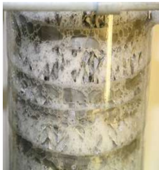
شکل ۱۲- فوم ایجاد شده در برج جذب واحد شیرین سازی گاز
