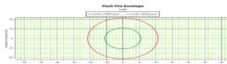
شکل ۱۴ - تغییرات غلظت برای ایجاد Flash Fire سناریوی نشتی ۱۰۰ میلی‌متر بر حسب فاصله زمستان
