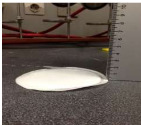
شکل ۱- اندازه گیری ضخامت کیک گل پلیمری محتوی کره های شیشه ای
