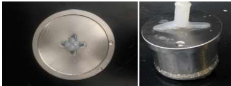
شکل ۶- دیسک شیاری (چپ) و مخروطی (راست) [5].
