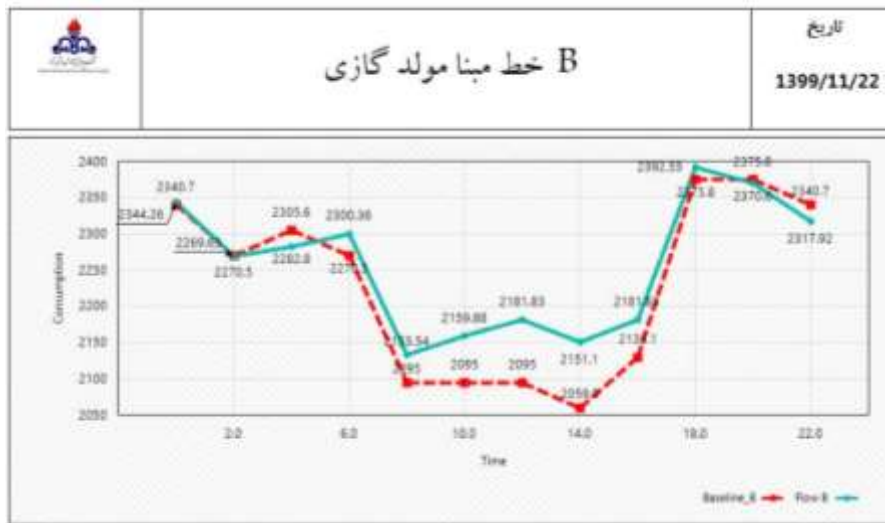
شکل ۷ - مقایسه عملکرد ۲۴ ساعته مولد گازی B با خط مینا بصورت دو ساعته
