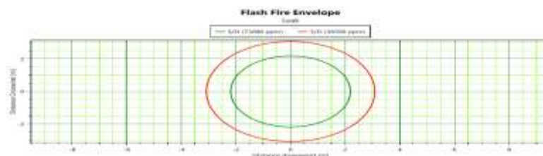
شکل ۲۳- میزان تشعشع ناشی از آتش ناگهانی در سناریو نشتی ۵ میلی‌متر و ارتفاع ۵ متر
