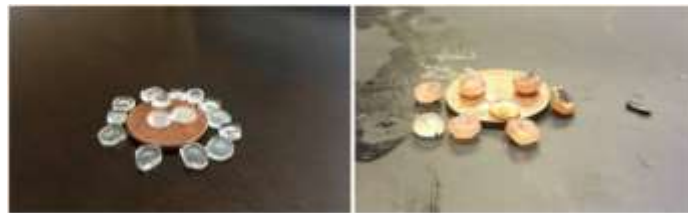
شکل ۲- مواد کنترل کننده هرزروی هوشمند قبل (چپ) و پس از فعال شدن (راست) [5]
