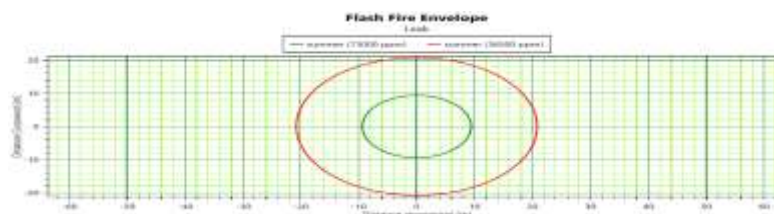
شکل ۱۳ - تغییرات غلظت برای ایجاد Flash Fire سناریوی نشتی ۱۰۰ میلی‌متر بر حسب فاصله تابستان
