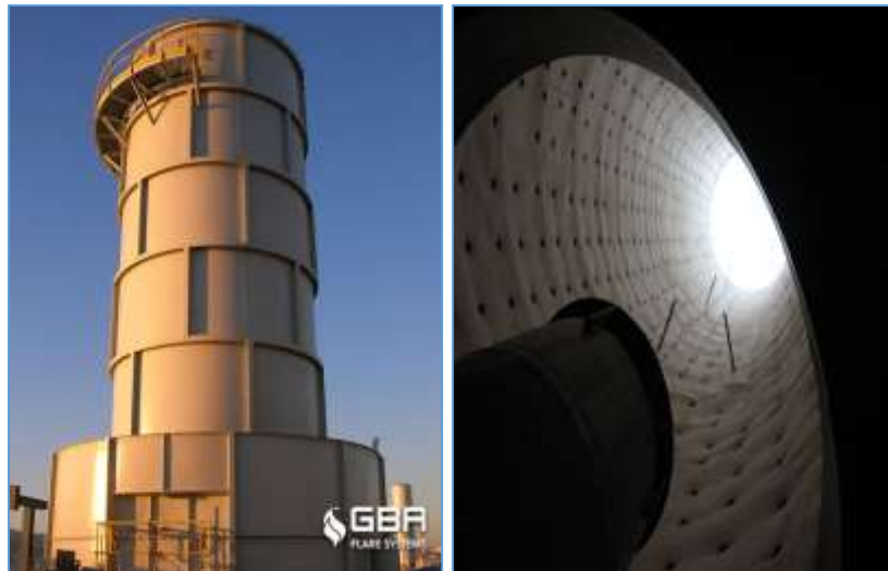
شکل ۳- مشعل بسته نمای درونی و بیرونی
