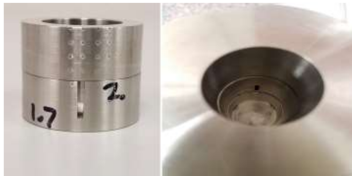
شکل ۴- شکاف با عرض ۲ میلی متر (چپ) و شکاف تعبیه شده در نگهدارنده مغزه (راست) [5].
