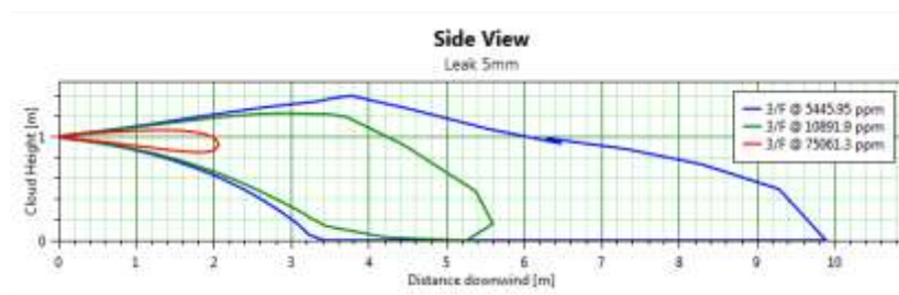
شکل ۱. نمای کنار ابربخار منتشرشده سناریوی Leak ۵ mm در فواصل مختلف از نشتی
