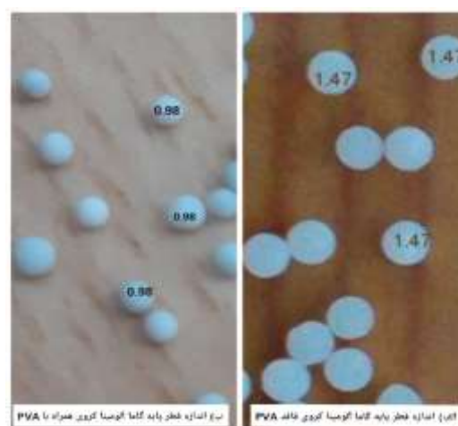
شکل ۵. اثر پلی وینیل الکل بر اندازه قطر حفرات پایه کروی گاما آلومینا
