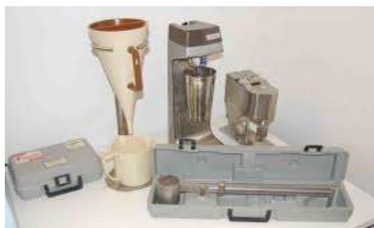
شکل ۲ - تجهیزات مورد نیاز برای ارزیابی اولیه نانو ذرات در سیال حفاری: گرانروی سنج - ترازوی گل - فیلتراسیون دما-فشار پایین - قلیانیت سنج.
